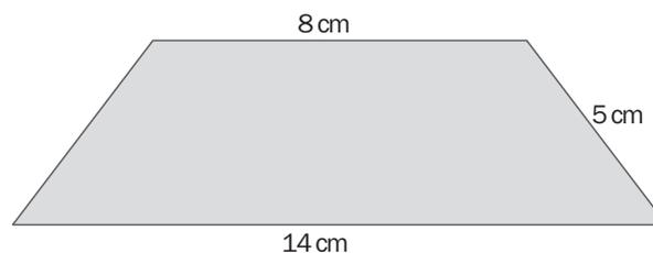
Usando el teorema de Pitágoras calculamos la altura:  $h^2 + 3^2 = 5^2 \Rightarrow h = 4 \text{ cm}$
