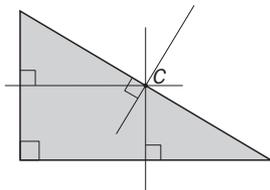
El circuncentro de un triángulo rectángulo coincide con el punto medio de la hipotenusa.
