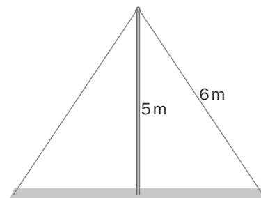
El poste forma un triángulo rectángulo con el suelo, de modo que aplicamos el teorema de Pitágoras:  $6^2 = 5^2 + b^2 \Rightarrow b = 3,32$ . Los cables se han sujetado a 3,32 m de la base del poste.
