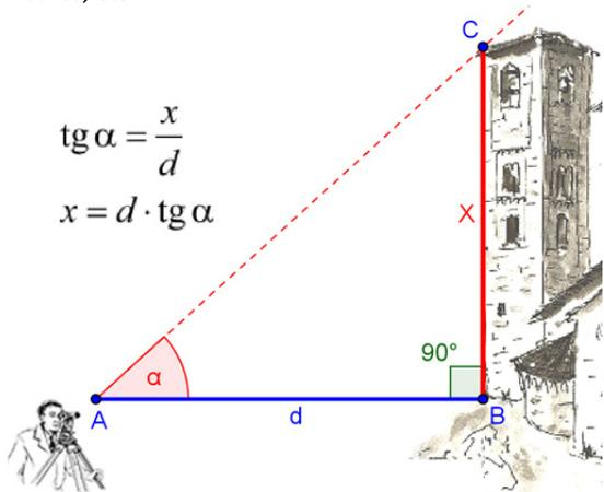
La distancia "d" se mide sobre el terreno, porque podemos llegar al pie (punto B). Para saber la amplitud del ángulo "α" utilizamos el teodolito.
