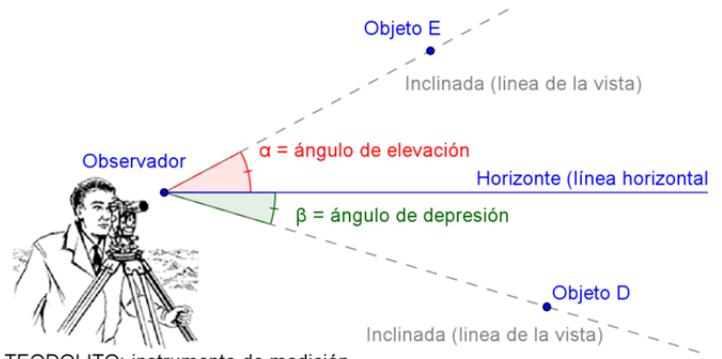
TEODOLITO: instrumento de medición mecánico-óptico que sirve para medir ángulos verticales y horizontales.
