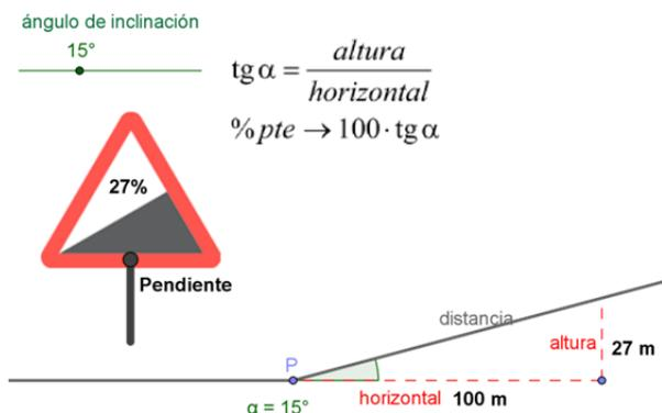
Si empleamos la distancia recorrida para calcular el ángulo, por ser más fácil de averiguar, debemos utilizar el seno, cometiendo un pequeño error por exceso (apreciable a partir de α > 15°).
