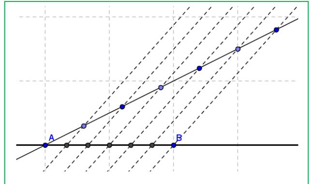
**Observa que** la figura obtenida es de triángulos en posición Tales, y que los segmentos obtenidos en  $AB$  son todos de igual longitud.
