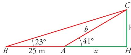
En el triángulo  $ABC$  conocemos dos ángulos,  $\hat{B} = 23^\circ$ ,  $\hat{A} = 180^\circ - 41^\circ = 139^\circ$ .
